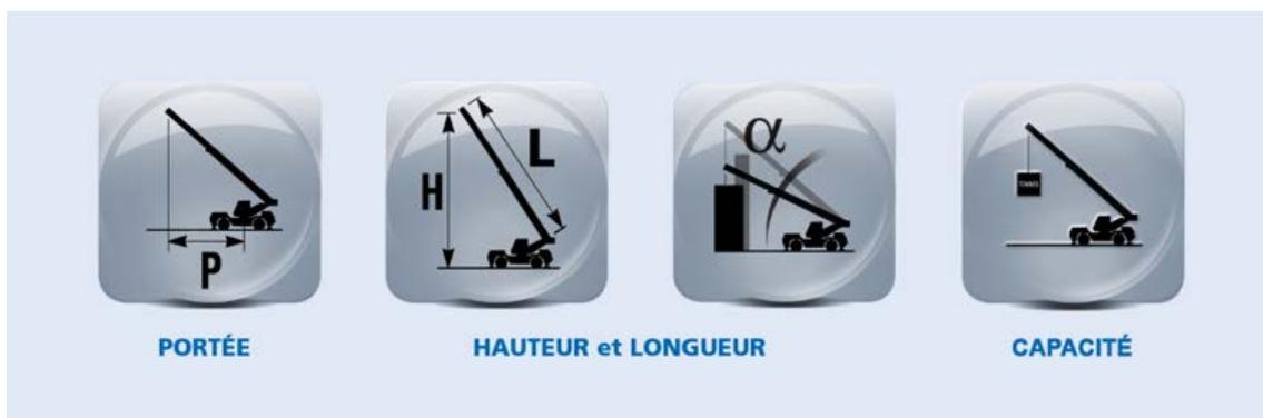
**P : portée** : distance horizontale du centre de rotation de la tourelle jusqu'au crochet en charge.
